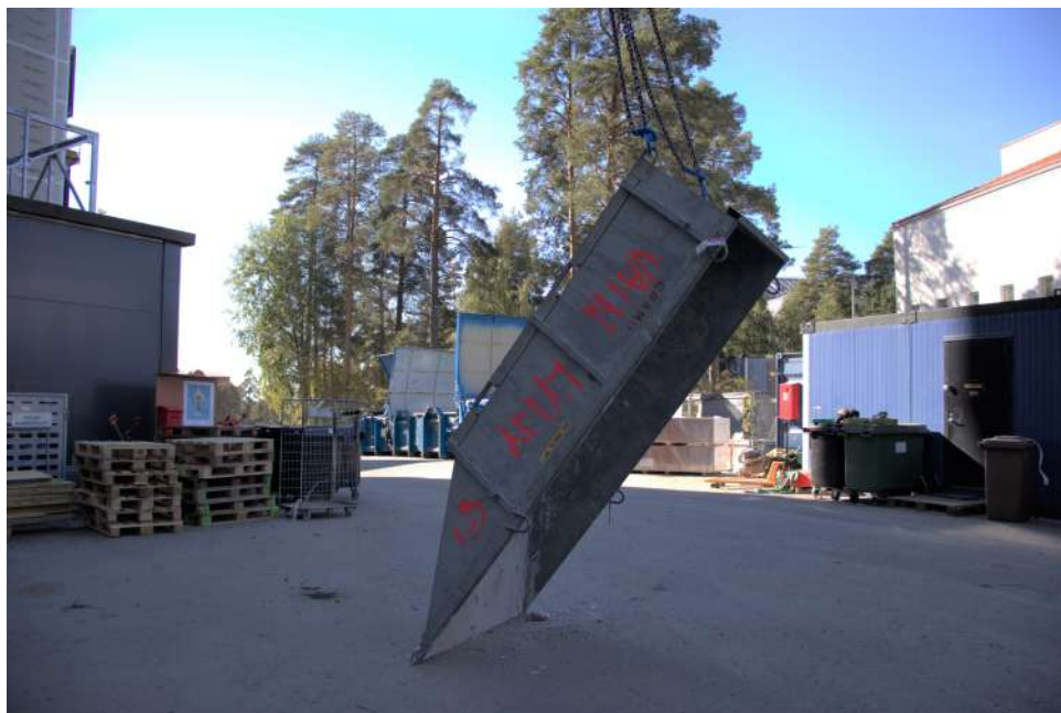
Kuva 45: Kuskin tarvitsee vain laskea suoraan alas, ja jassikka alkaa kaatumaan ylösalaisin. Kuva: Mikko Tourunen
