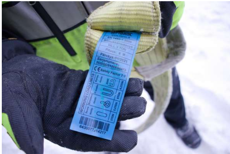
Kuva 53: WLL 3 TON. Kuva: Mikko Tourunen
