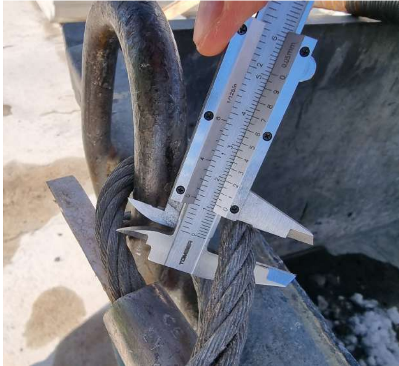
Kuva 95: Sinkin paksuus näyttää olevan noin 10mm. Kuva: Mikko Tourunen
