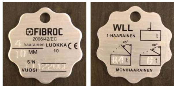
Kuva 71: 10 mm paksujen nelihaaraisten ketjujen kuormakilpi. Kuva: Mikko Tou-runen
