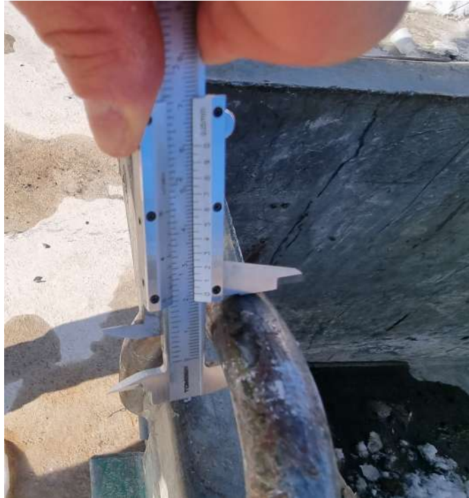
Kuva 94: Jassikan nostolenkin paksuus näyttää olevan noin 20mm. Kuva: Mikko Tourunen
