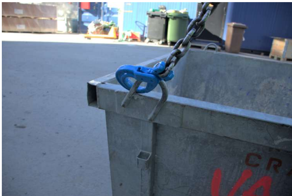
Kuva 42: Väärälle puolelle jätetty koukku on jäänyt pantteeseen, ketjut takaisin löysälle, ja asetat sen koukun lenkin oikealle-, eli sisäpuolelle. Kuva: Mikko Tourunen
