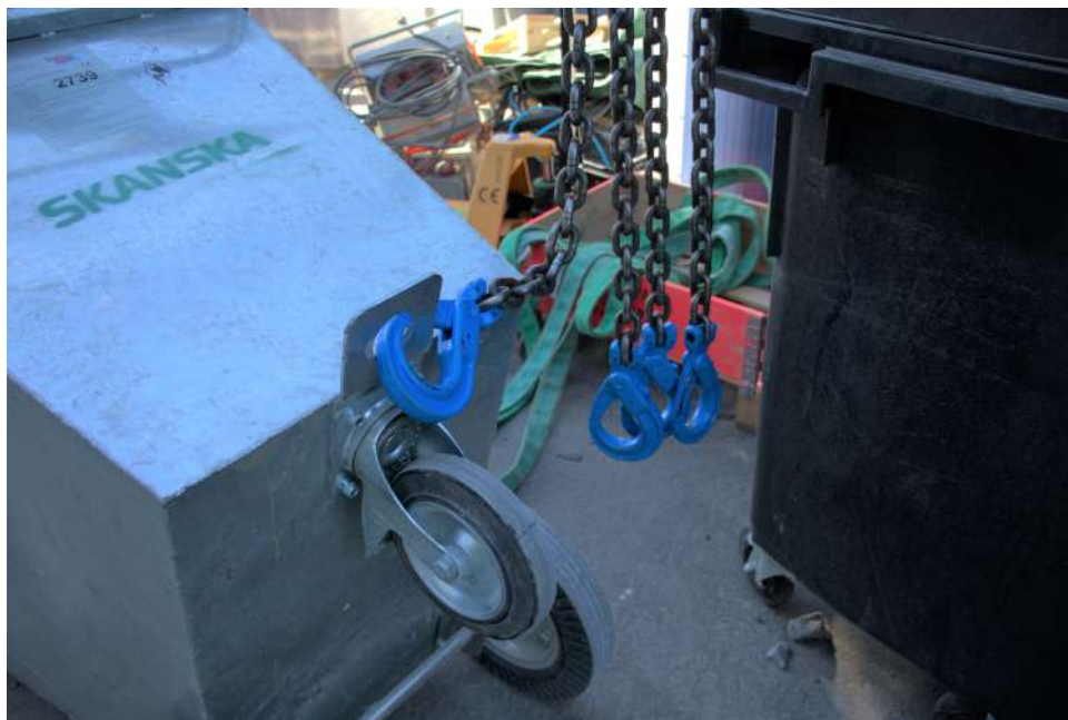
Kuva 32: Kerroskärryn tyhjennyslenkki. Yksi ketju lenkissä kiinni, loput ylimääräisiä, joita ei jätetä näin. Kuva: Mikko Tourunen
