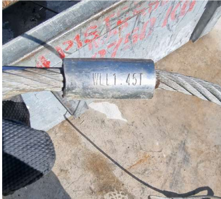
Kuva 93: Sinkin WLL 1.45t. Hirtto antaa kertoimen 0.8, eli jäljellä oleva nostoarvo 0.8 \times 1.45 = 1.16\text{t} . Kuva: Mikko Tourunen
