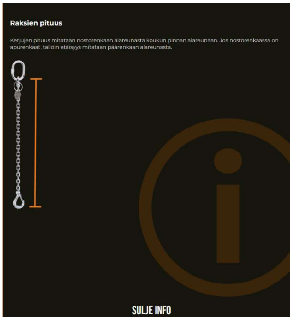
Kuva 84: Ketjujen pituuden mittaaminen
