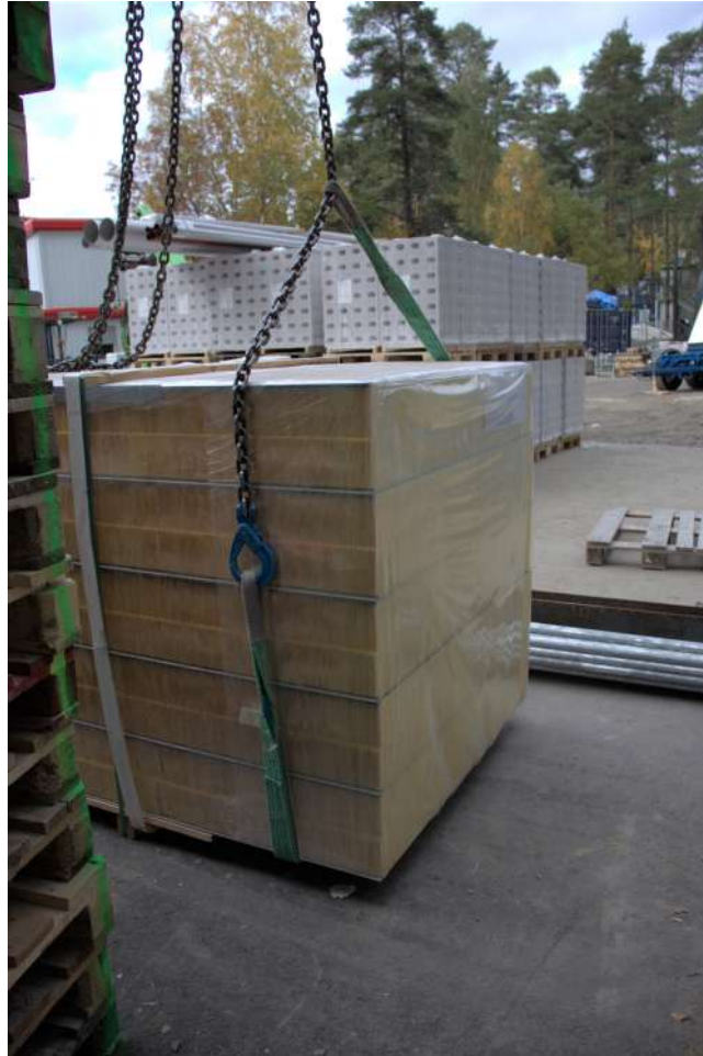
Kuva 62: Jatkohirtto. Tässä hieman erikoisempi sidonta. Sopii tilanteeseen jossa taakka pitää sitoa hirttämällä, mutta liinan pituus ei riitä. Tätä katsoessa herää kysymys, mikä on muotokerroin? Aina kun nostossa on mukana useampi nostoapuväline, täytyy muistaa sanonta ”Ketju on yhtä vahva, kuin sen heikoin lenkki”. Eli kun on useampi nostoapuväline mukana, noston rasitusaste määritetään sen heikoimman mukaan. Ja mikä se olisi tässä kuvan esimerkissä? Oma ratkaisuni on: vihreään liinaan sovelletaan muotokerrointa 2, ja ketjuun muotokerrointa 0.8. Kuvassa olevat ketjut ovat 4 t ketjut, joten niiden maksimi kapasiteetiksi tässä määriteltäisiin 4 \times 0.8 = 3.2t . Kuva: Mikko Tourunen
