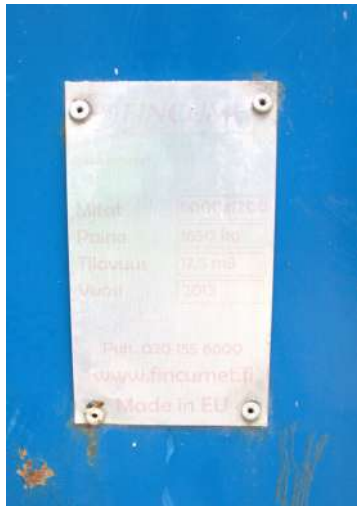
Kuva 51: Tässäkään lavassa ei ole minkään sortin merkintää maksimi nostokapasiteetista, joten tätä ei nostoapuvälineenä saa käyttää. Kuva: Mikko Tourunen
