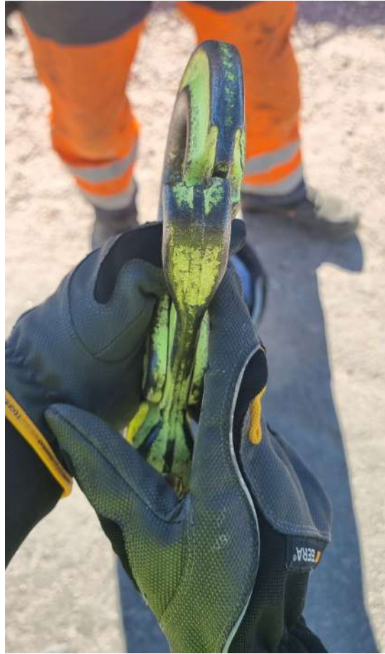
Kuva 41: Vaikka se koukku teidän käsissä vaikuttaakin olevan vahva teräksinen kappale, niin niiden voimien rinnalla, jota nosturi pystyy tuottamaan, se on hyvin-kin pehmeä. Tulette vääntämään niitä bumerangiksi, jos ette ole tarkkana miten asettelette sen nostolenkkiin. Kuva: Mikko Tourunen
