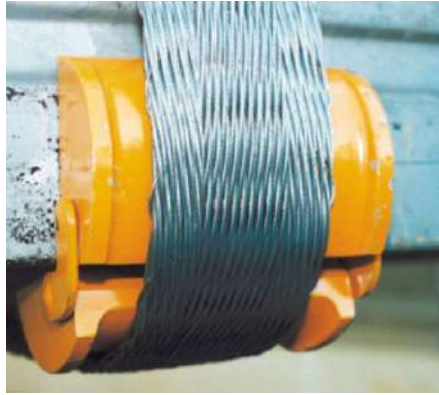
Kuva 96: Tässä yksi esimerkki kulmasuojasta
