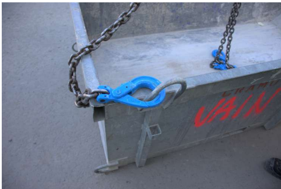
Kuva 40: Kuvassa koukku jätetty lenkin ulkopuolelle, eli väärälle puolelle. Usein, jos nostolenkki on riittävän tilava, kuten kuvan lenkki on, se koukku pyörähtää sieltä itsekseen oikealle puolelle. Mutta myös tämän lenkin kanssa, ja varsinkin vähän ahtaampien lenkkien kanssa se ei pyörähdä sieltä oikealle puolelle, vaan jää pantteeseen sellaiseen kulmaan, että nosto pitää keskeyttää, laskea taakka alas, ja asettaa se koukku oikein siihen lenkkiin. Kuva: Mikko Tourunen.
